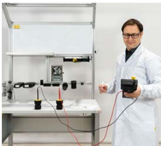
Selon IEC 61340, vos solutions ESD sont vérifiées à l'aide d'appareils de mesure étalonnés et seront livrés accompagnés d'un protocole de mesure.
