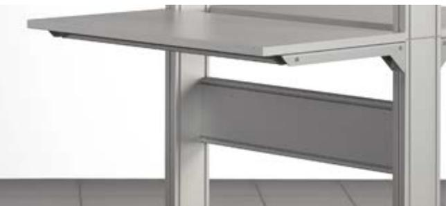
Les plans de travail sont installés à droite et à gauche avec les supports de plan de travail 8 sur les colonnes de table. Des séries de perçages permettent de raccorder des éléments de base porteurs, des deux côtés sur les supports de plan de travail 8.
