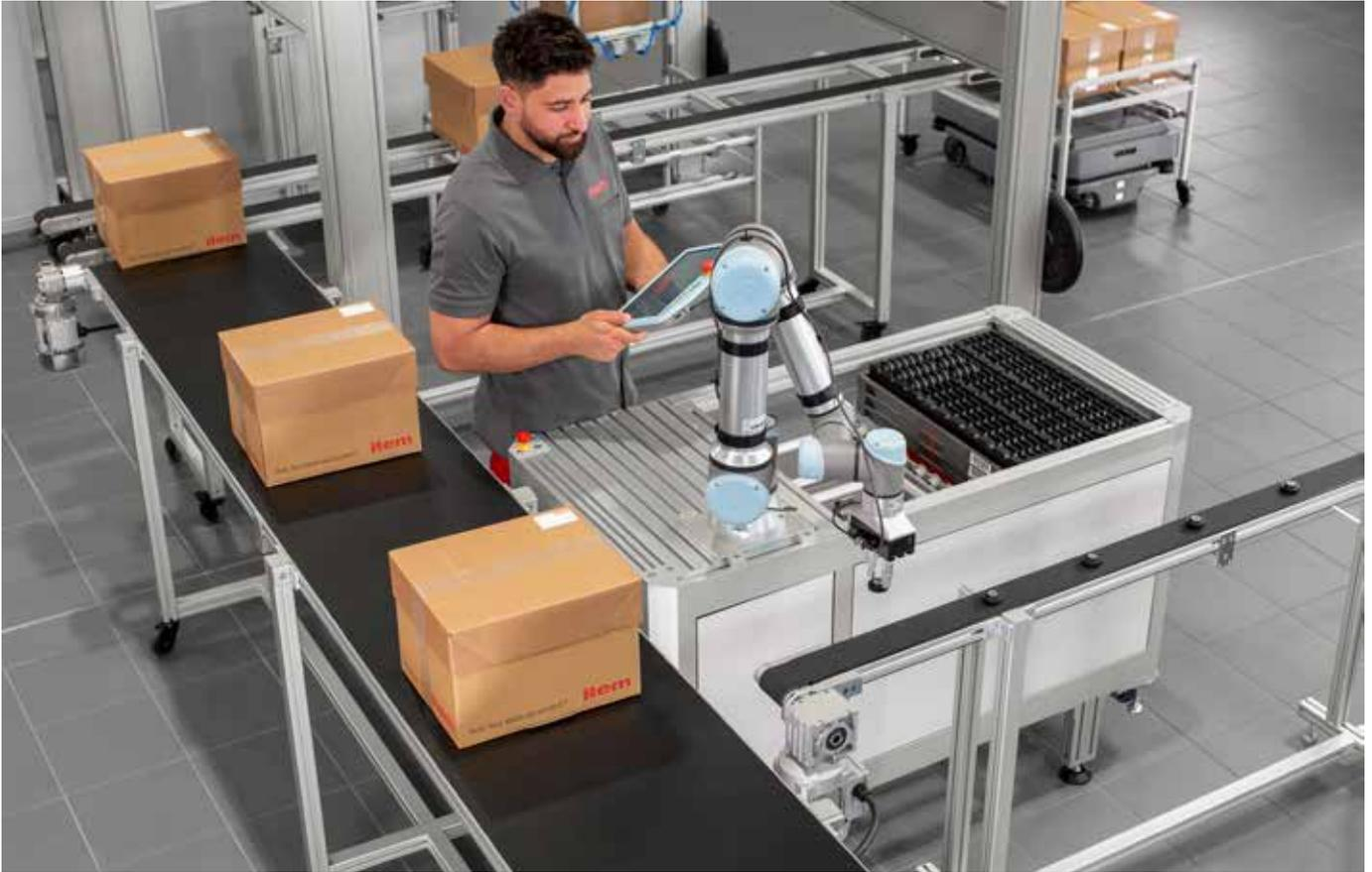
Un convoyeur en fonctionnement cadencé permet de synchroniser deux processus de travail. Le prélèvement des produits peut ainsi être réalisé de manière automatisée ou semi-automatisée. Il est possible par exemple de regrouper efficacement des articles individuels dans des unités de conditionnement plus grandes. L'intégration sans problème des processus facilite la suite du transport dans l'entrepôt ou l'expédition par convoyeur ou par système de transport sans conducteur (STSC).
