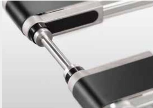
Le kit de synchronisation relie les deux poulies d'entraînement et transmet le couple à l'unité suivante. Les accouplements à moyeu expansible sont simplement installés dans les arbres creux des poulies. Le tube D16x1,5 St (0.0.664.14) sert d'arbre de synchronisation. Le profilé cache arbre de synchronisation 8 40 (0.0.710.31) couvre l'arbre tournant.
